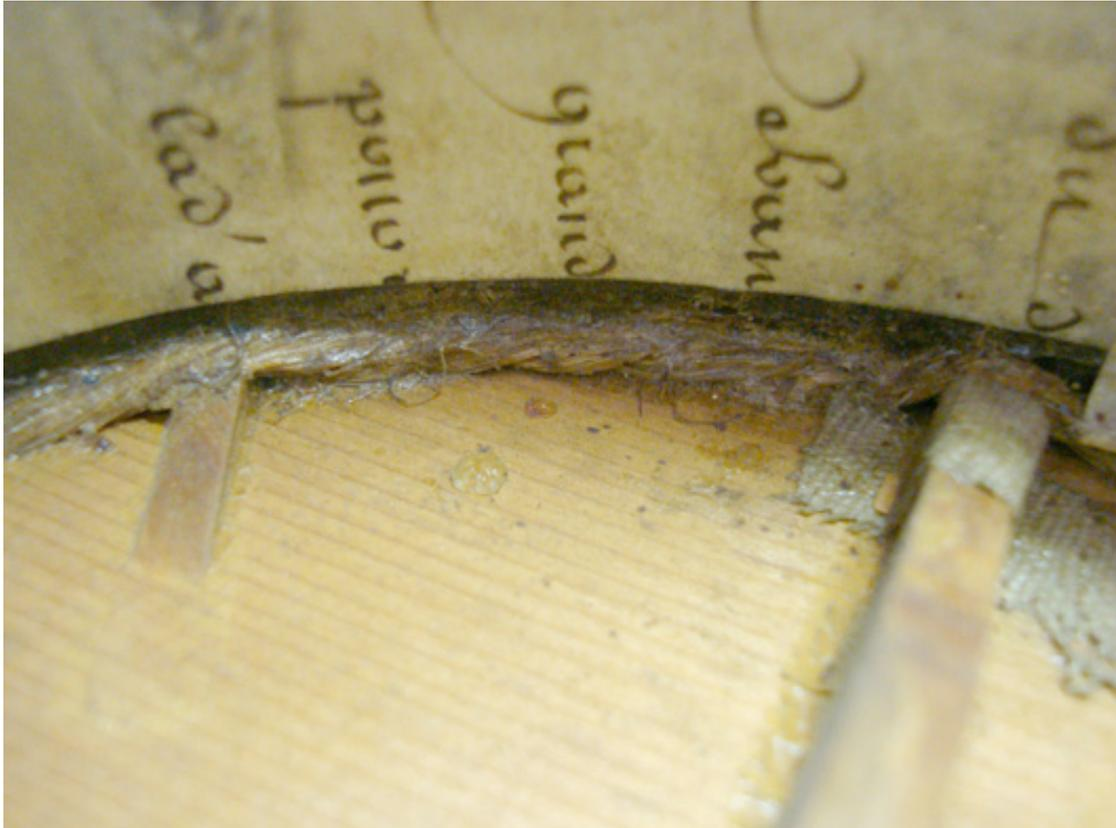
*Les taquets de positionnement et la barre, sous la ficelle.*
